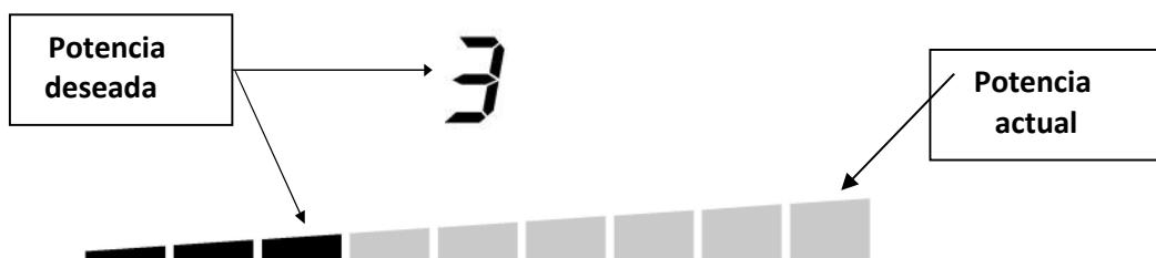
Los segmentos de la zona de selección de potencia se irán apagando de uno en uno hasta que se alcance el nivel de potencia deseado.
