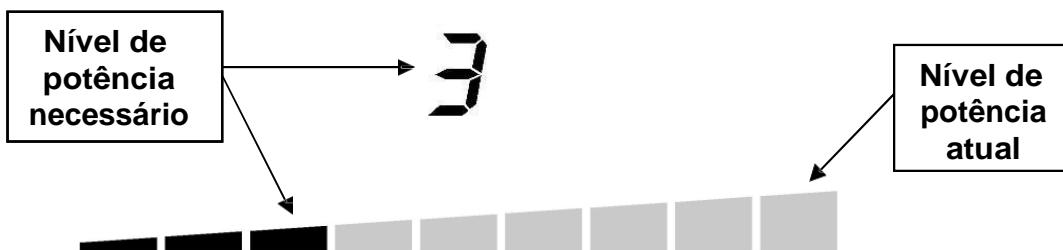
Os segmentos do visor de potência desligam-se um a um até ser atingido o nível de potência necessário.
